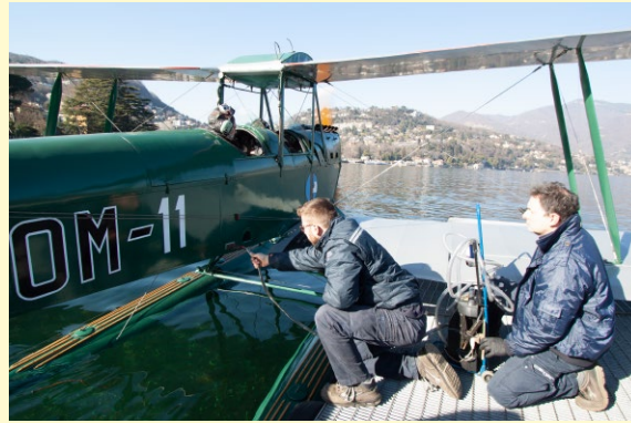
Carlo Novati in partenza per un volo. Il motore è appena stato avviato grazie alla batteria esterna e l'assistente sta togliendo gli spinotti dalle prese poste sul fianco della fusoliera.
