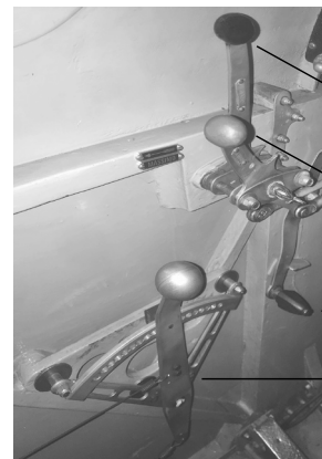
manetta del gas manetta dell'anticipo manetta della miscela ("Alta Quota") trim
